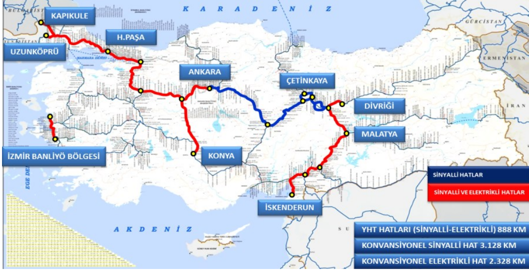
Şekil 3.1.2.1 Sinyalizasyon ve Elektrifikasyon Sistemleri
