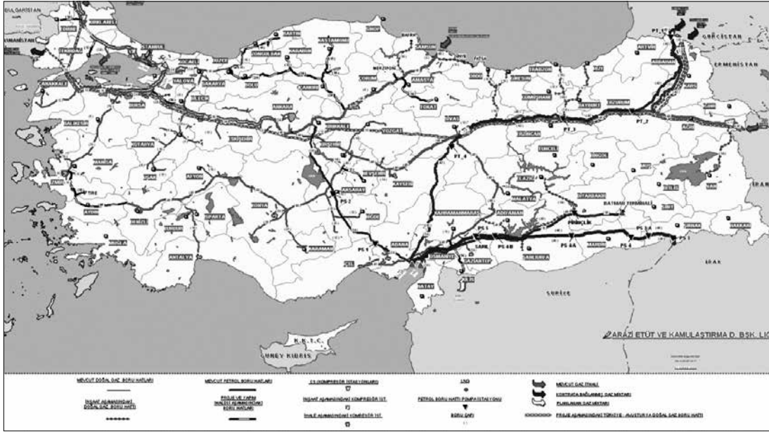
Şekil 5.5. Mevcut Doğalgaz İletim ve Dağıtım Kanalları
